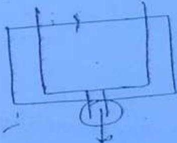
$$\left(\frac{dU}{dt}\right)_{CV} = m_e h_i + \dot{Q} - m_e h_e - \dot{W}$$
